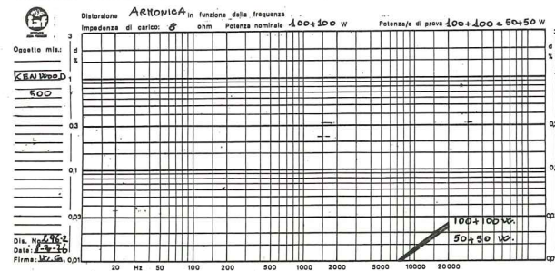
Distorsione armonica totale in funzione della frequenza 100 +100 W (linea continua) e a 50+50 W (linea tratteggiata). Canale sinistro; canale destro praticamente coincidente.
